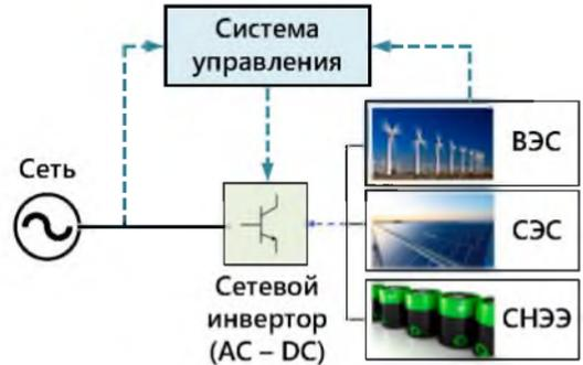
*Типовая структура СП на базе трехфазного двухуровневого статического преобразователя напряжения*
