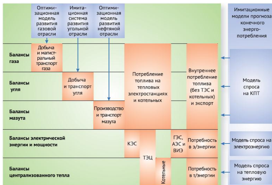
Рисунок 4 – Структура оптимизационной модели развития электроэнергетики в ТЭКе «EPOS»
