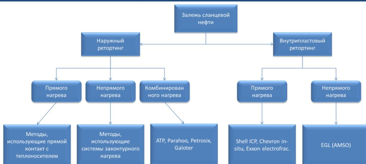
**Рисунок 3 - Схема процессов обработки сланцевых плеев для получения нефтяного сырья**
