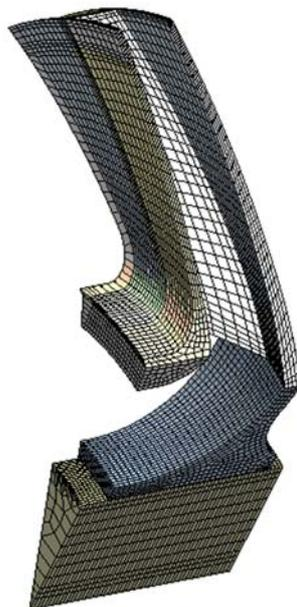
**Рис. 3.** КЭ модель вала и колеса при учете циклической симметрии (сектор 1/17).
