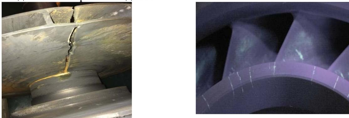
Рис. 1. Повреждения колес 1-ой - 4-ой ступеней компрессора.
