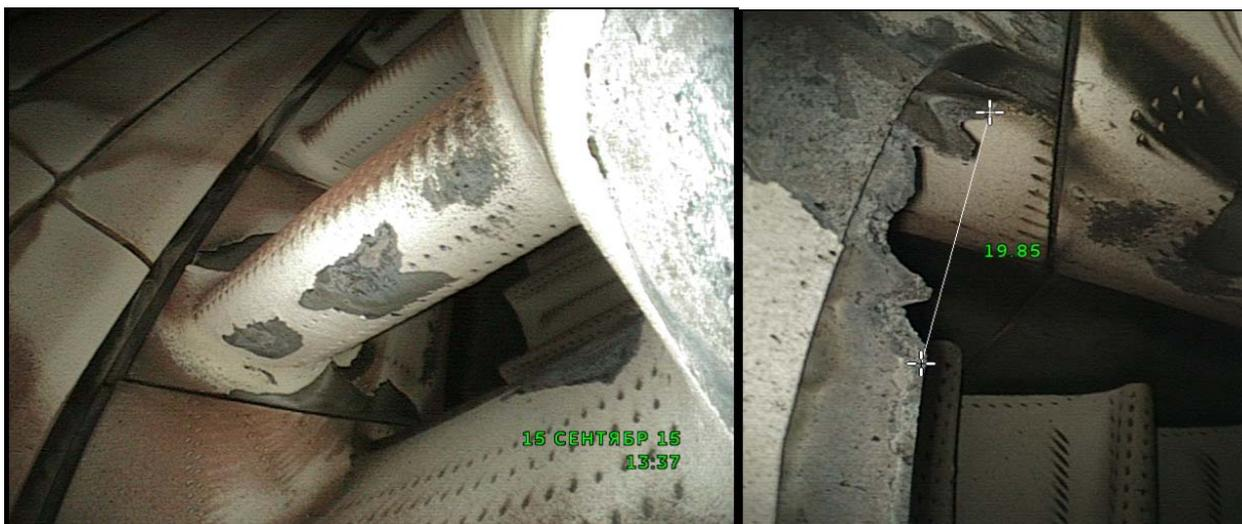
Рис. 4. Повреждения модифицированной сопловой лопатки
