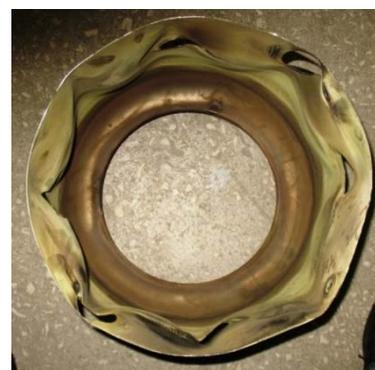
Рис. 2. Деформация камеры сгорания после эксплуатации (вид снизу КС с разрезанным дном)
