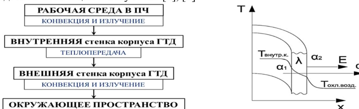
Рис.1. Основной механизм передачи тепла от корпуса ГТД к окружающему пространству
