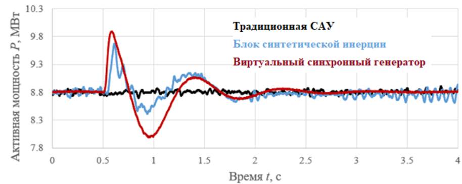
Рис. 14. Осциллограммы активной мощности при увеличении нагрузки в слабой сети
