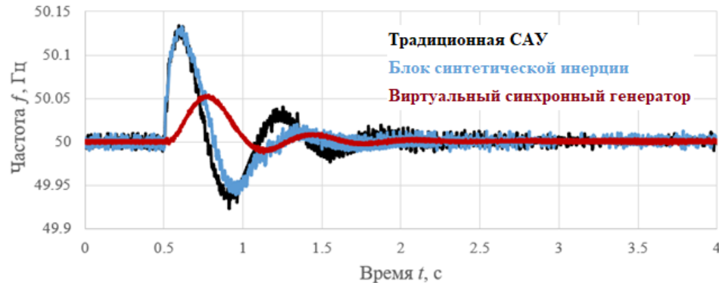
Рис. 13. Осциллограммы частоты при увеличении инсоляции в слабой сети
