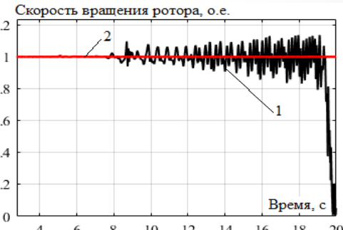
Рис.4. Скорость ротора турбогенератора (а) и гидрогенератора (б) при отключении основного питания
