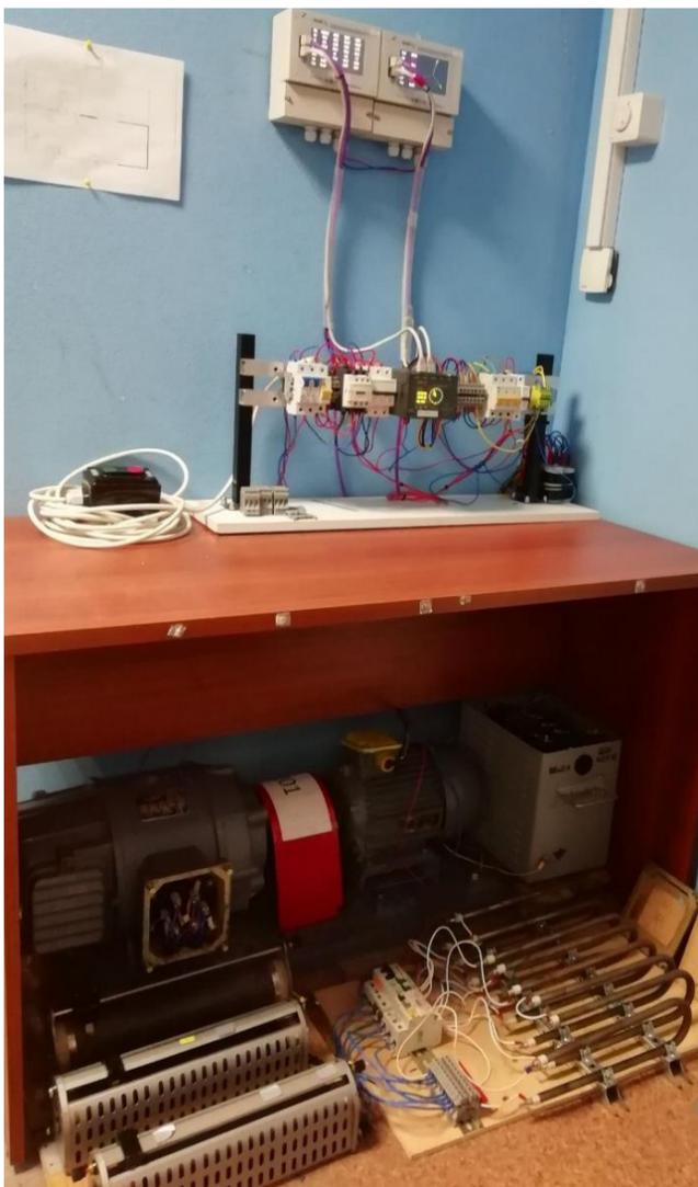
стенд с однофазным трансформатором
