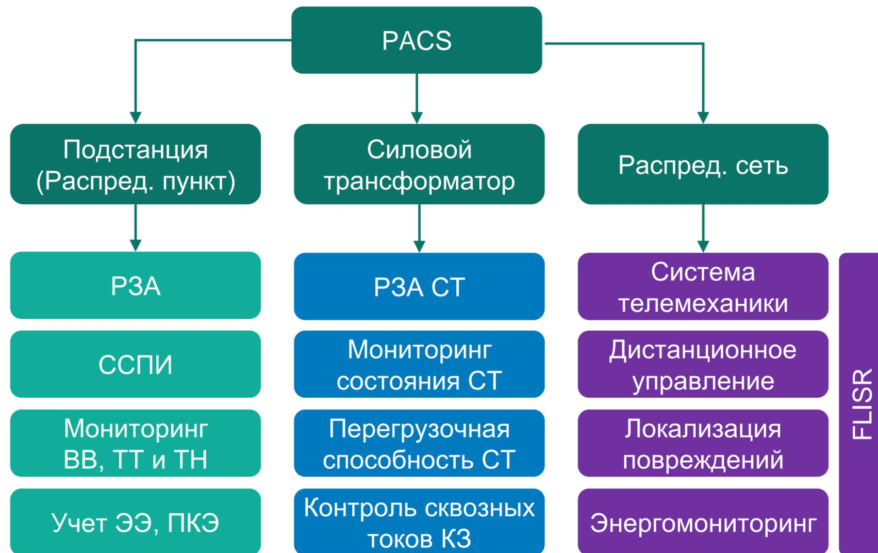
**PACS (Protection, automation, and control system)** – система защиты, автоматизации и управления
