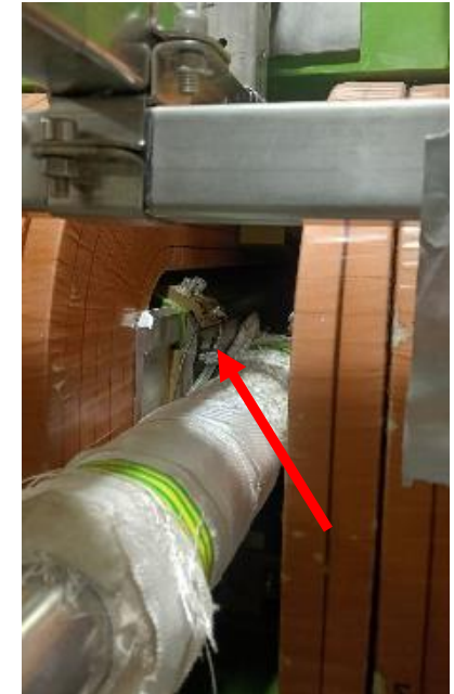
Рис.7. Расположение датчика в магните
