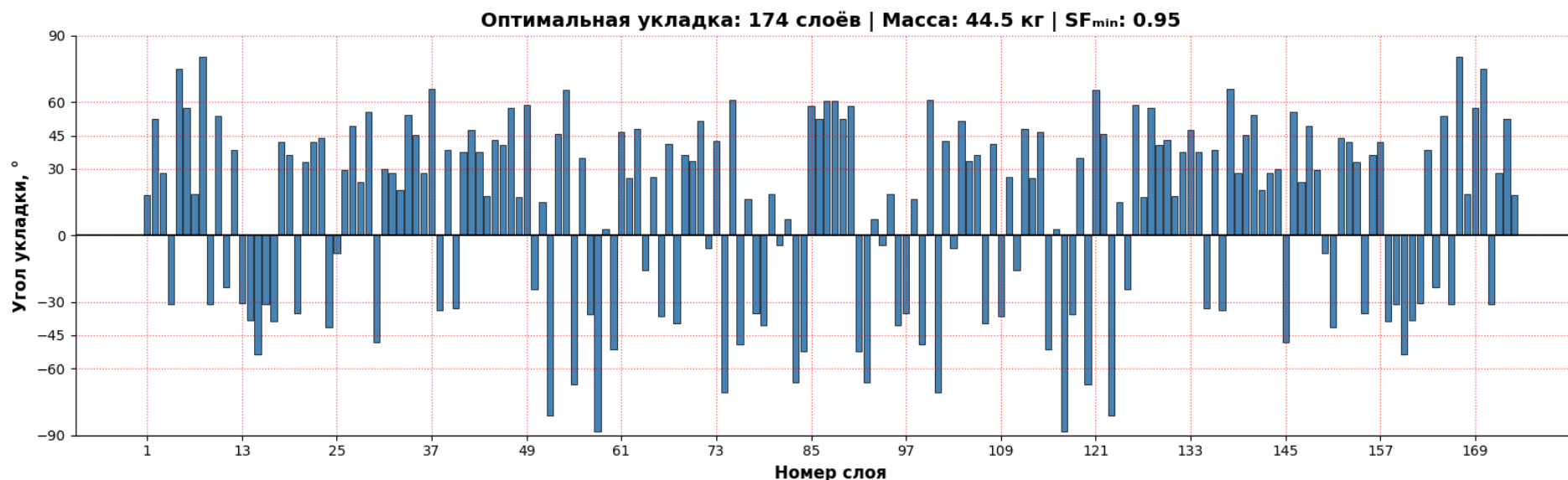
Рис.3 График укладки с непрерывными углами
