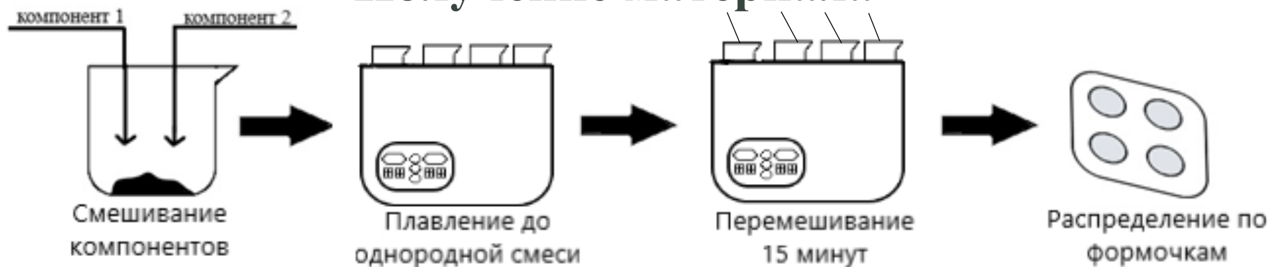
Рисунок 1 — Схема получения смесей
