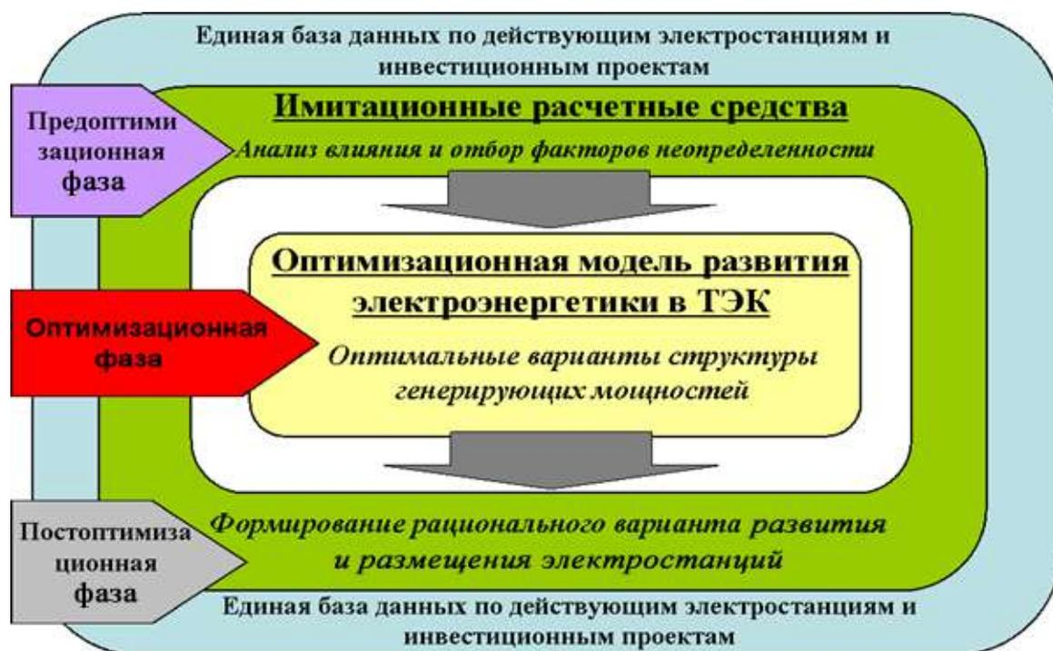
Рисунок 3 – Принципиальная схема интеграции имитационных и оптимизационных методов и моделей в системе прогнозирования развития электроэнергетики
