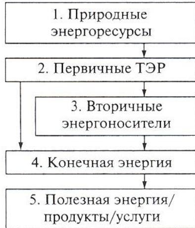
Рис. 1. Схема трансформации ТЭР
