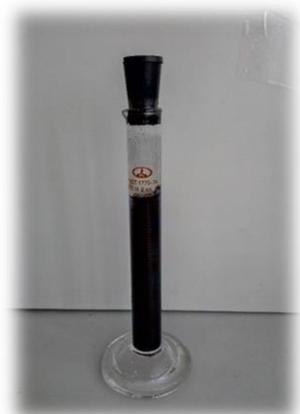
Графеновый нанокolloид; базовая жидкость – дистиллированная вода
