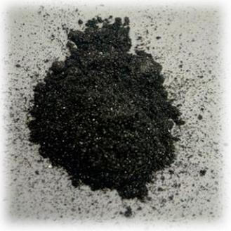
Нанопорошок графена: хлопья расщепленного в сильном ультразвуковом поле графита; размер 3-10 мкм, толщина менее 3 нм
