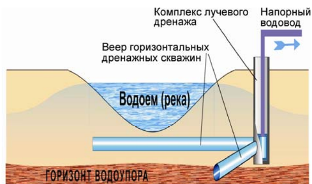
Рис. 9. Схема подруслового водозабора, осуществляемого с использованием системы лучевого дренажа
