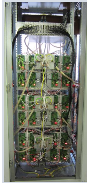
Фаза полупроводникового коммутатора ФПУ
