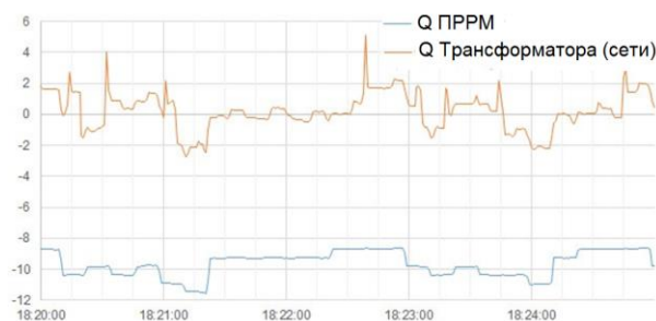
Динамика переключения ступеней ПРРМ в автоматическом режиме
