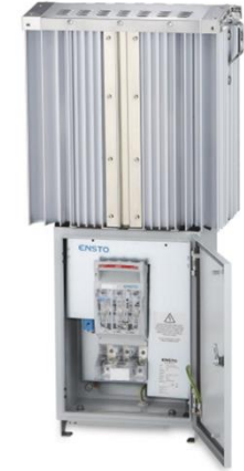
Фильтр нулевой последовательности – трансформатор специального исполнения, компенсирующий токи нулевой последовательности сети.
