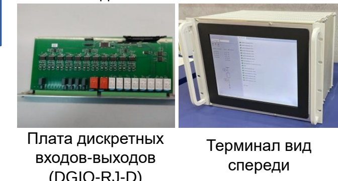
Рис. 4 – Моделирование работы ИЭУ (задание аналоговых и дискретных сигналов)
