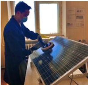
I. Очистка ФЭП от пыли
