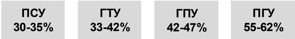
Рис. 37. Электрический КПД различных тепловых электростанций
