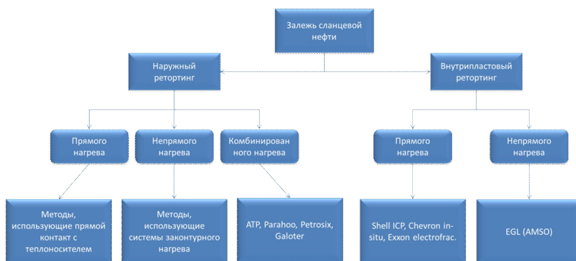
Рисунок 9 - Схема процессов обработки сланцевых плеев для получения нефтяного сырья Источник: ИНЭИ РАН.
