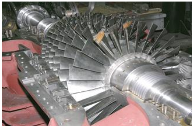
Испытания модельного 6-ти ступенчатого отсека компрессора на стенде ЦКТИ
