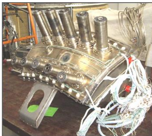
Испытания сектора кольцевой камеры сгорания на стенде ПАО СМ и ГП Ивченко прогресс
