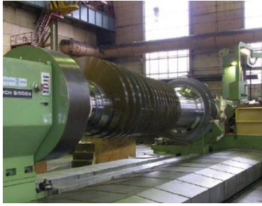
Токарная обработка роторов (Вальдех)
