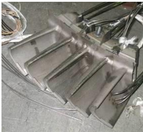
Испытания охлаждаемых лопаток 1-2 ступени на стенде ЦКТИ
