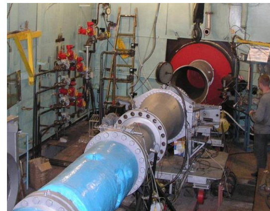
Испытания сектора кольцевой камеры сгорания на стенде ПАО СМ и ГП Ивченко прогресс
