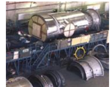
Стенд горизонтальной сборки ГТ
