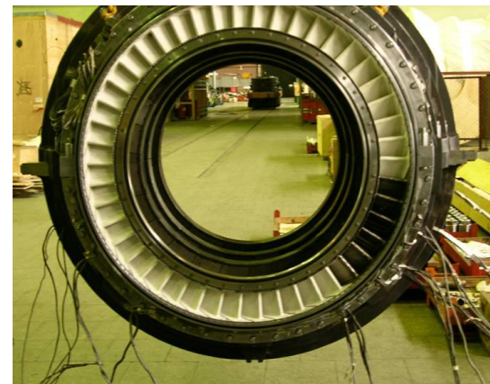
Оснащение измерительными датчиками узлов компрессора, КС и турбины в составе ГО ГТЭ-65 на ТЭЦ-9
