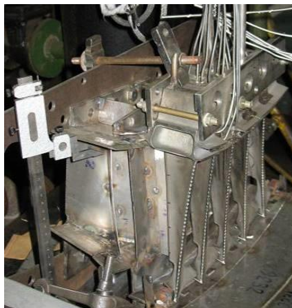
Испытания охлаждаемых лопаток 1-2 ступени на стенде ЦКТИ
