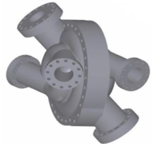
3-D модель корпуса блока парогазовой турбины
