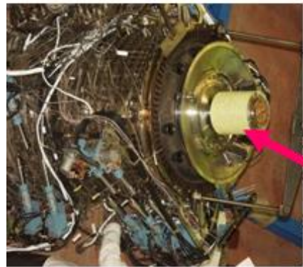
Паровой компрессор ХМ 1МВт с ЭД ( n=10000 об/мин)
