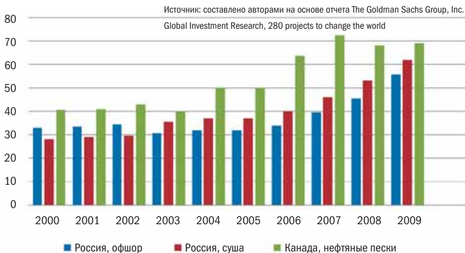
Рис. 5. Изменение средних удельных проектных затрат на баррель традиционной нефти в России и битуминозных песков в Канаде, долл./ барр. (2008)
