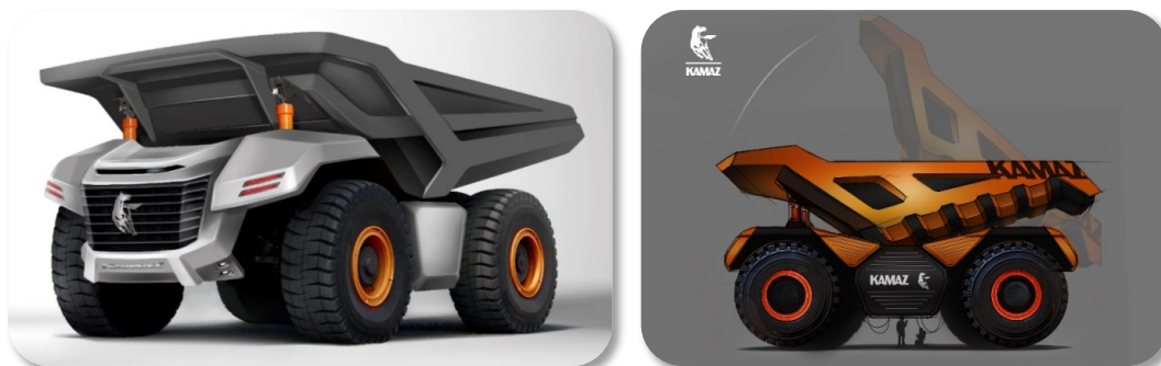
Рисунок 1. Облик беспилотного автосамосвала грузоподъемностью 220 т
