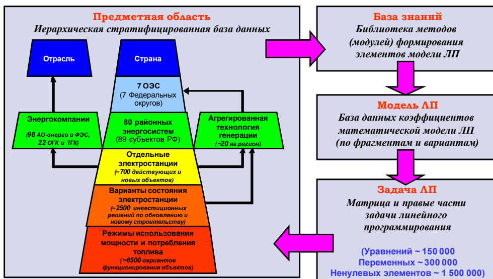
Рис. 3. Принципиальная схема технологии организации многовариантных оптимизационных расчетов при прогнозировании развития электроэнергетики
