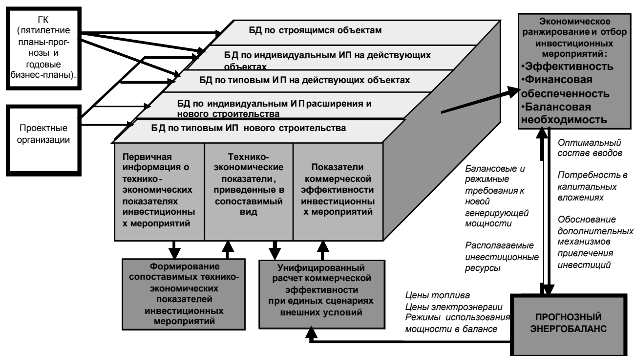
Рис. 4. Схема организации работ по обоснованию развития генерирующих мощностей в рамках среднесрочного планирования в электроэнергетике
