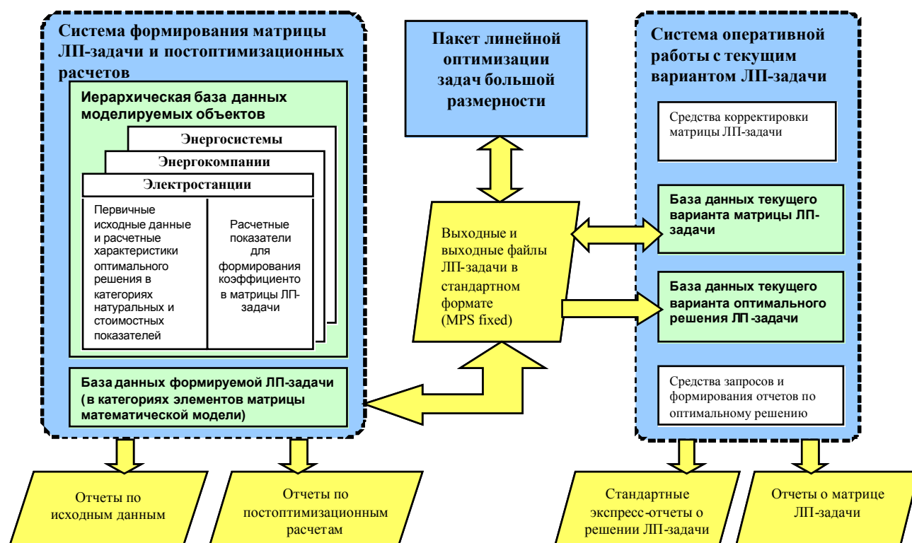
Рис. 8. Схема компьютерной реализации производственно-финансовой модели развития электроэнергетики
